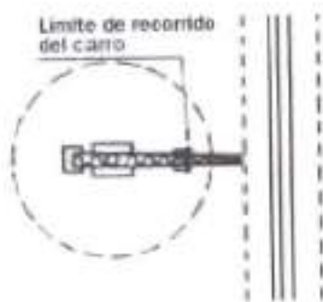
Fig. 5. Esquema de limitació del recorregut d'un carro d'una grua torre.
