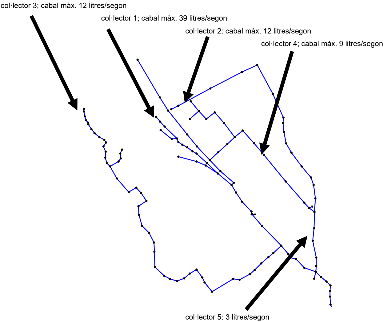
Figura 20. Estructura topològica de la xarxa actual amb els cabals màxims aplicats
