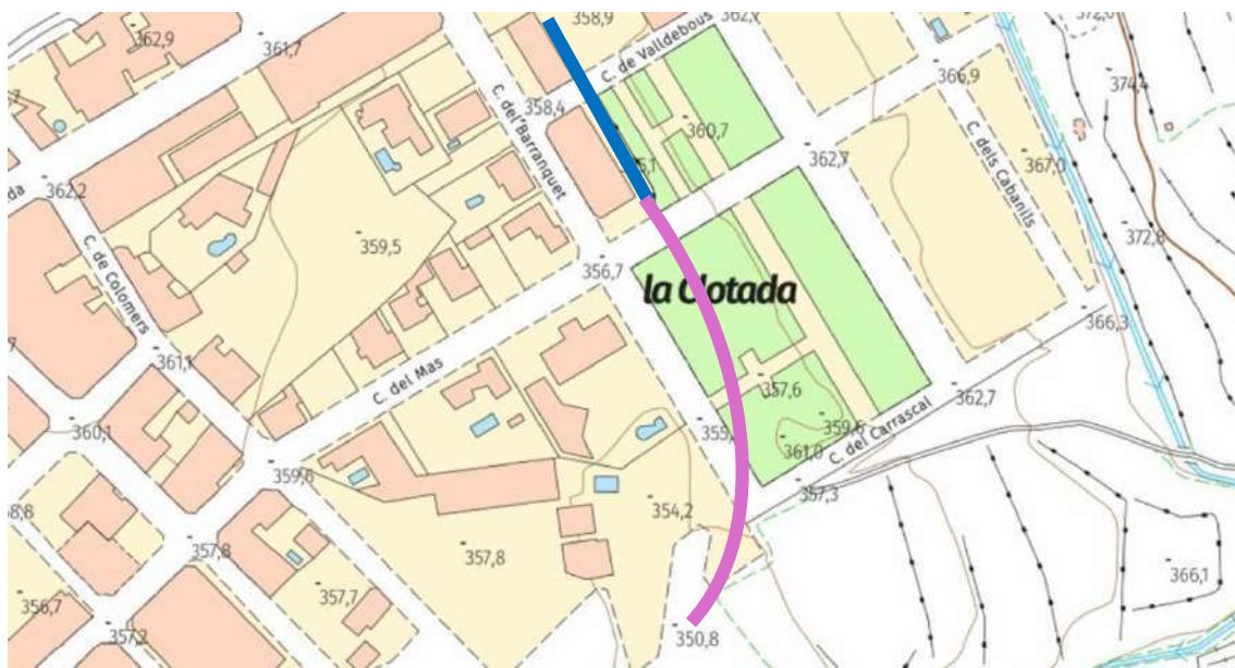
Imatge 5. Esquema del col·lector antic del carrer Barranquet. En blau està el col·lector rectangular i en lila és el col·lector circular.
