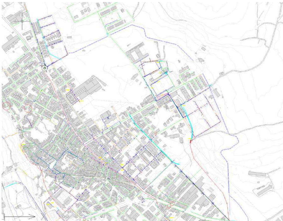
Imatge 2. Xarxa de sanejament del municipi (residual + pluvial). Color blau+cyan correspon als pluvials i verd, vermell i taronja als residuals.
