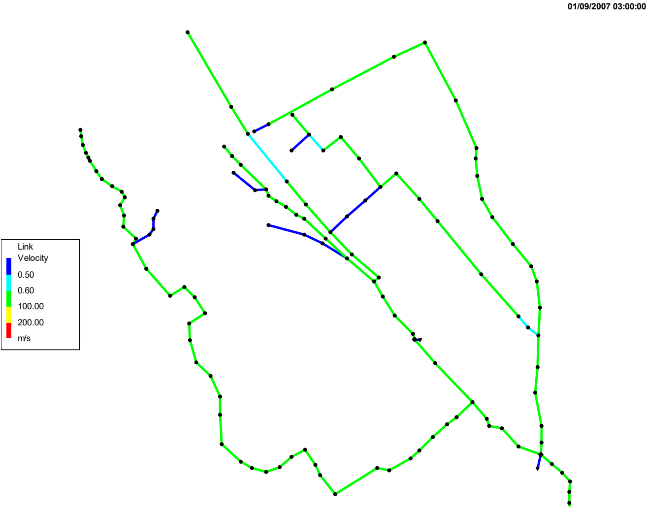
Figura 22. Velocitats de la xarxa d'aigües residuals
