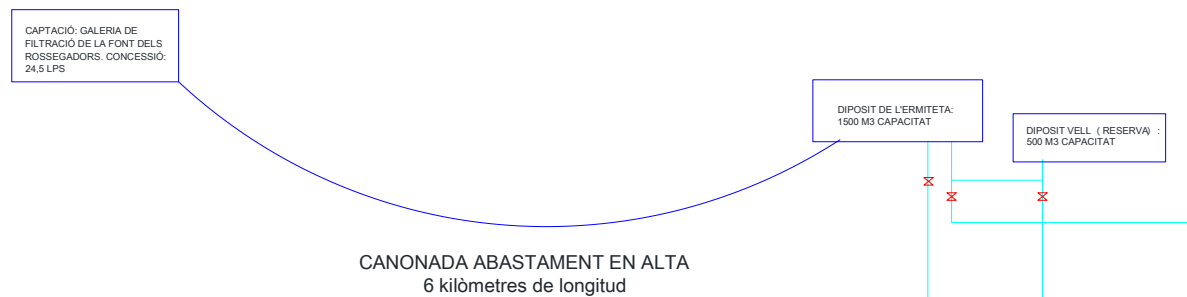
Imatge 2. Esquema del sifó de la canonada d'abastament en alta del municipi
